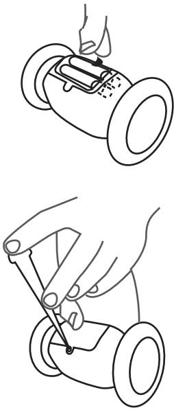
Zum einfacheren Entfernen der Batterien ist ein Zugband angebracht. Stellen Sie beim Einlegen der neuen Batterien sicher, dass sich das Zugband unter den Batterien befindet.
